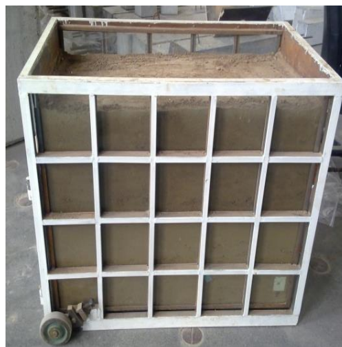
شکل ۳- مخزن ساخته شده برای نگهداری خاک Fig. 3. A tank built to store soil
