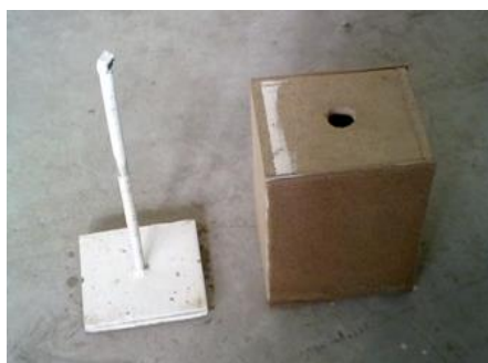
شکل ۵- وزنه مورد استفاده برای متراکم نمودن نمونه
