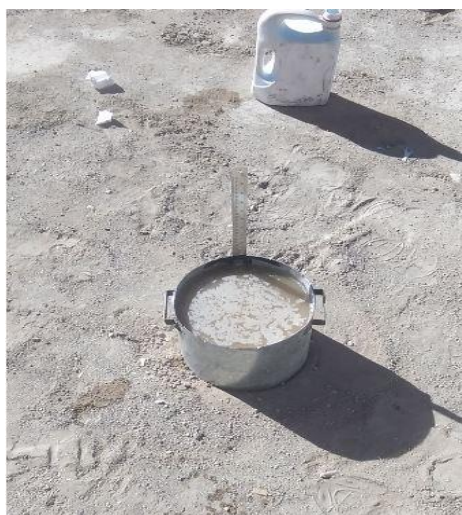
شکل ۱۶- آزمایش اندازه‌گیری نرخ نفوذپذیری با استفاده از استوانه تک در سطح زمین چاهک شماره ۲
