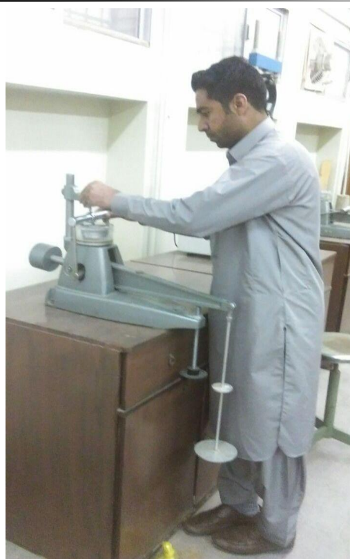
شکل ۱۴- تعیین ضریب رمبندگی خاک بر اساس معیار جنینگز و نایت در دستگاه ادئومتر
