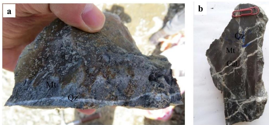
شکل ۱۱-ا) مگنتیت که توسط رگچه کوارتز قطع شده است. (ب) ماده معدنی که توسط رگچه‌های کلسیتی و کوارتزی قطع شده است. رگچه‌های کربناتی، رگچه‌های کوارتزی را نیز قطع کرده است. (مگنتیت: Mt، کوارتز: Qz، کلسیت: Cal). علائم اختصاری کانی‌ها برگرفته از ویتنی و اوانز (Whitney and Evans, 2010) می‌باشند.
