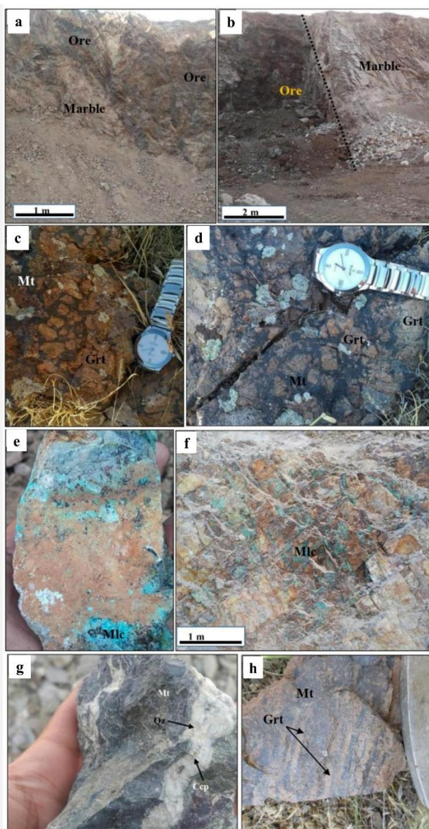
شکل ۶- تصاویر صحرایی از کانه‌زایی در بخش غربی اسکارن آهن صاحب. (a) کانه‌زایی آهن به صورت رگه- رگچه‌ای در واحدهای کربناتی دگرگون شده (مرمر) پرمین (b) کانه‌زایی آهن در هورنفلس‌های کرتاسه. (c, d) بلورهای گارنت برشی شده در زمینه‌ای از مگنتیت. (e, f) تشکیل کانه‌های سوپرژن از جمله مالاکیت، آزوریت و اکسیدهای آهن (g) رگچه‌ای از کوارتز که ماده معدنی مگنتیت را قطع کرده است. قطعه برشی کالکوپیریت در این رگچه مشاهده می‌گردد. (h) بافت نواری گارنت و مگنتیت در کانسار صاحب. (کوارتز: Qz، مگنتیت: Mt، گالن: Grt، مالاکیت: Mlc). علائم اختصاری کانی‌ها برگرفته از ویتنی و اوانز (Whitney and Evans, 2010) می‌باشند.
