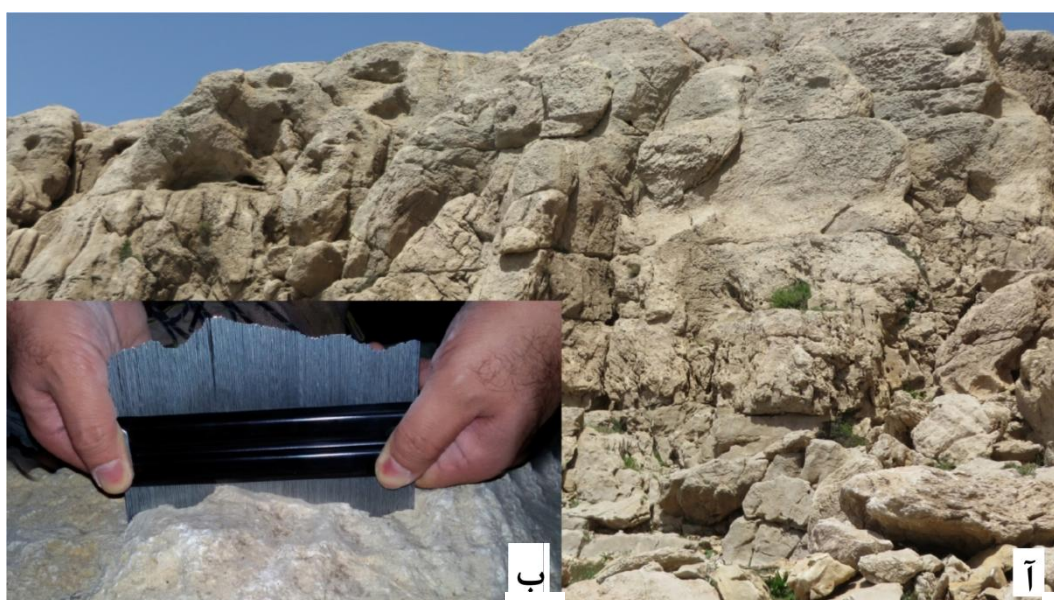
شکل ۳. (آ) نمایی از توده سنگ آهک ایلام-سرود در منطقه بررسی شده، (ب) نمای نزدیک از اندازه‌گیری مقطع زبری سطح سنگ با شانه بارتن ۱۵ سانتی‌متری
