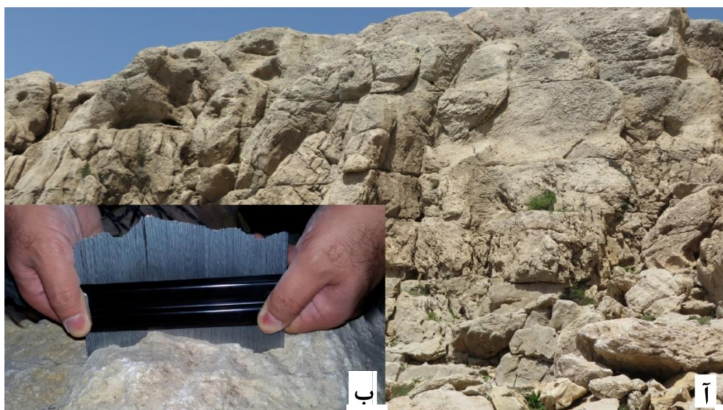
شکل ۳. (آ) نمایی از توده سنگ آهک ایلام-سروک در منطقه بررسی شده، (ب) نمای نزدیک از اندازه گیری مقطع زبری سطح سنگ با شانه بارتن ۱۵ سانتی متری
