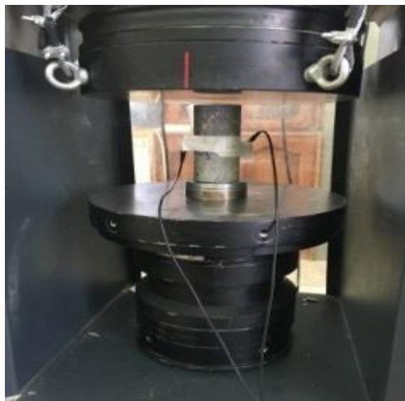
شکل ۳. نحوه قرارگیری و نصب سنسورهای آکوستیک
