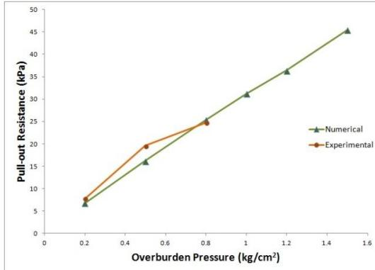
شکل ۲۴- اثر تغییرات فشار سربار اعمالی برای وزن مخصوص خشک ۱/۶ gr/cm³
