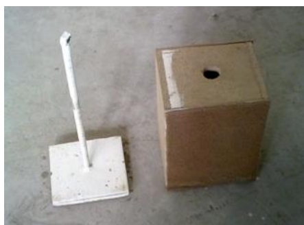
شکل ۵- وزنه مورد استفاده برای متراکم نمودن نمونه
