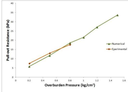
شکل ۲۳- اثر تغییرات فشار سربار اعمالی برای وزن مخصوص خشک ۱/۴ gr/cm³
