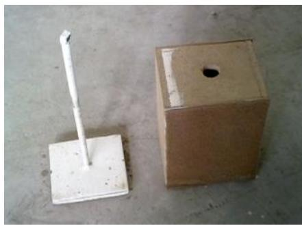
شکل ۵- وزنه مورد استفاده برای مترکم نمودن نمونه
